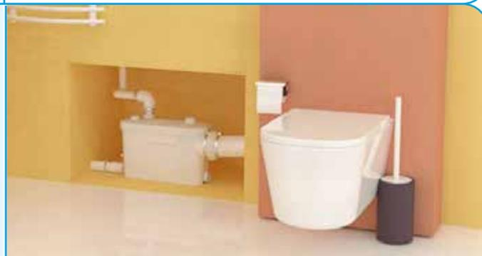
**Art. P.883.00 - Pumpe Typ MAC 400 A mit Zerkleinerer für die Entsorgung von Abwasser und Fäkalien aus Kellerräumen mit Sammelbehälter und 3 Anschlüssen: WC, Waschbecken, Dusche. Geeignet für hängende WC-Becken.**
